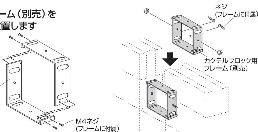
フレームの左右にネジを通してモルタルでブロックに固定します。横積みの場合は上下にネジを通して固定します。
