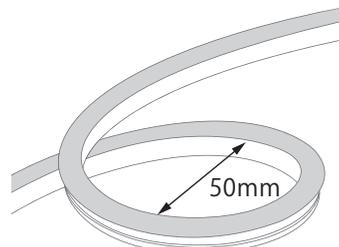
○曲げ直径が50mm以下になるように曲げないでください。
