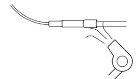
端子被服材をドライヤー等の熱で収縮させ、防水圧着端子内部の接着剤が電線に密着している事を確認してください。ドライヤー等の熱で電線被覆が溶けないように注意してください。
