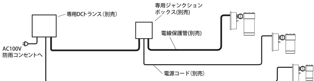
コンクリート、モルタルなどへ配線する場合は、電源コードを電線保護管(別売)に必ず通し、不乾性パテ(別売)で止水処理を行い、メンテナンスができるように施工してください。
