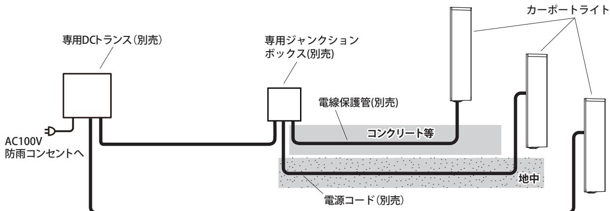
コンクリート、モルタルなどへ配線する場合は、電源コードを電線保護管(別売)に必ず通し、不乾性パテ(別売)で止水処理を行い、メンテナンスができるように施工してください。
