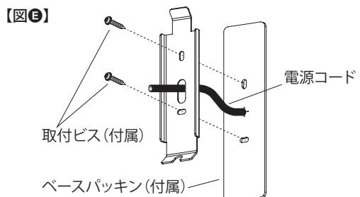
3. 取付金具とベースパッキンを取付ビス(付属)で、補強材のあるところに取り付けてください。
