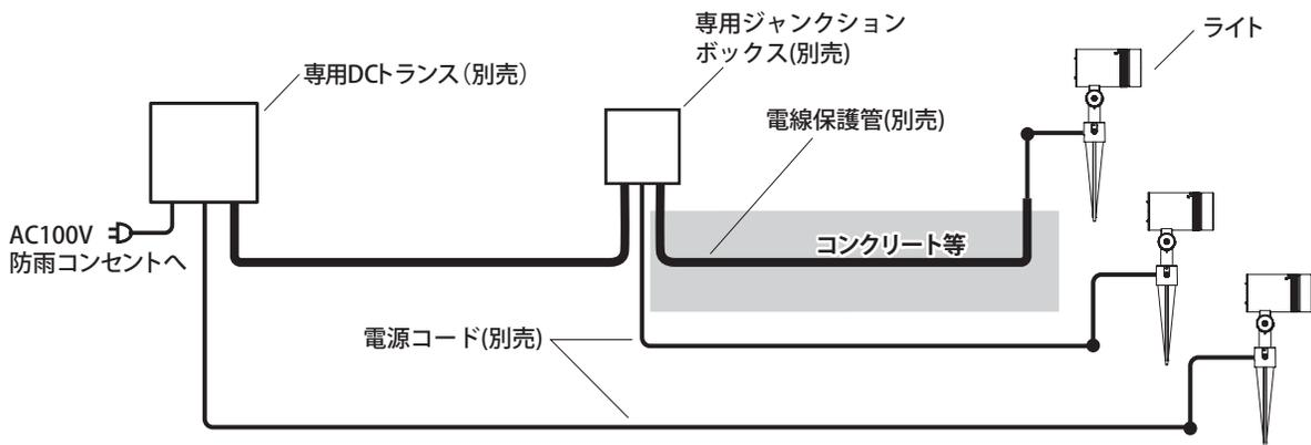
コンクリート、モルタルなどへ配線する場合は、電源コードを電線保護管 (別売) に必ず通し、不乾性パテ (別売) で止水処理を行い、メンテナンスができるように施工してください。
