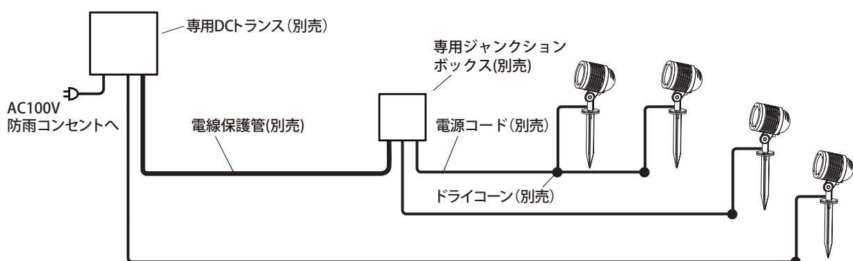
コンクリート、モルタルなどへ配線する場合は、電源コードを電線保護管(別売)に必ず通し、不乾性パテ(別売)で止水処理を行い、メンテナンスができるように施工してください。
