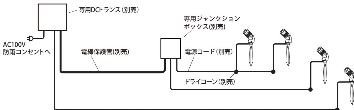
コンクリート、モルタルなどへ配線する場合は、電源コードを電線保護管(別売)に必ず通し、不乾性パテ(別売)で止水処理を行い、メンテナンスができるように施工してください。
