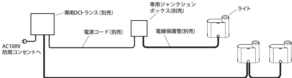
コンクリート、モルタルなどへ配線する場合は、電源コードを電線保護管(別売)に必ず通し、不乾性パテ(別売)で止水処理を行い、メンテナンスができるように施工してください。
