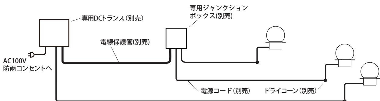
コンクリート、モルタルなどへ配線する場合は、電源コードを電線保護管(別売)に必ず通し、
