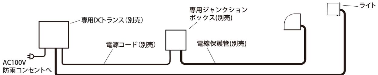
コンクリート、モルタルなどへ配線する場合は、電源コードを電線保護管(別売)に必ず通し、不乾性パテ(別売)で止水処理を行い、メンテナンスができるように施工してください。
