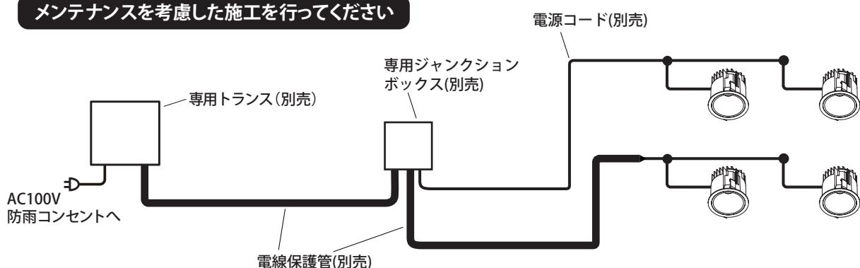
電源コード(別売)を電線保護管(別売)に通して施工する場合には、不乾性パテ(別売)で止水処理を行い、メンテナンスができるように施工してください。
