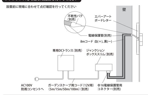
コンクリート、モルタルなどへ配線する場合は、電源コード(別売)を電線保護管(別売)に必ず通し、不乾性パテ(別売)またはブッシング(別売)で止水処理を行い、メンテナンスができるように施工してください。
