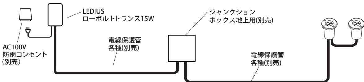
※コンクリート・モルタルへの施工の場合は、電源コードを電線保護管（別売）に必ず通し、不乾性パテ(別売)で止水処理を行ってください。
