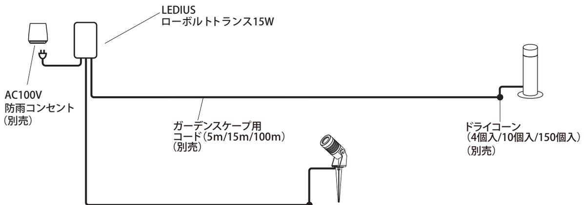
※電線保護管を使用しない場合、LEDIUSローボルトトランスからのガーデンスケープ用コードは同時に2本まで取り付けが行えます。
