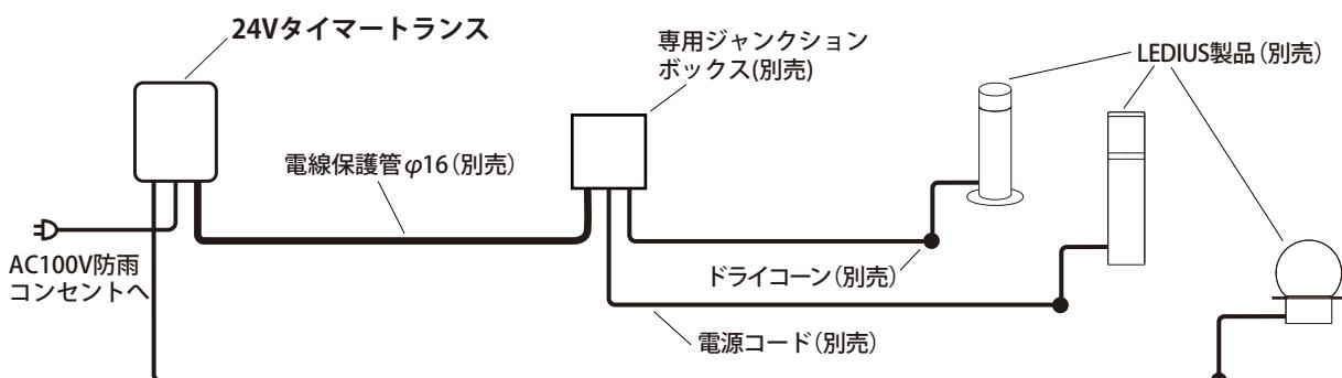
コンクリート、モルタルなどへ配線する場合は、電源コードを電線保護管（別売）に必ず通し、不乾性パテ（別売）で止水処理を行い、メンテナンスができるように施工してください。
