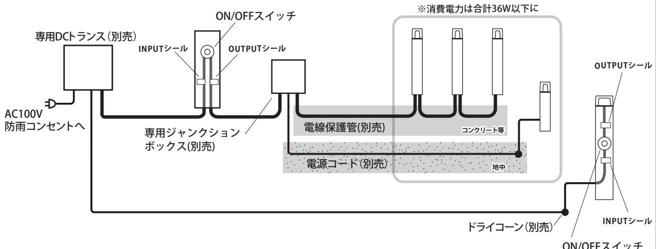
コンクリート、モルタルなどへ配線する場合は、電源コードを電線保護管(別売)に必ず通し、不乾性パテ(別売)で止水処理を行い、メンテナンスができるように施工してください。
