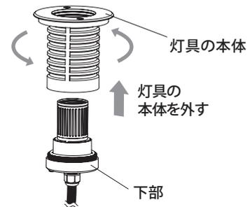
3 モジュールを回し灯具から外します。コネクターを抜きます。
