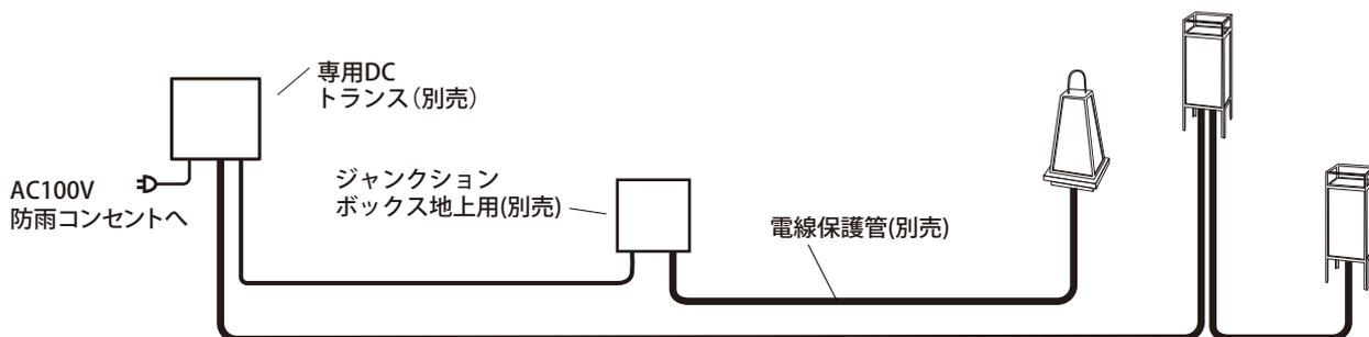
※地中配線の場合は、電源コードを電線保護管(別売)に必ず通し、不乾性パテ(別売)で止水処理を行ってください。
