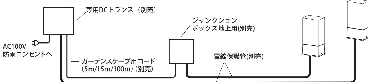
※コンクリート・モルタルなどへの地中配線の場合は、電源コードを電線保護管(別売)に必ず通し、不乾性パテ(別売)で止水処理を行ってください。
