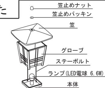
図1 ランプ、グローブ、笠の取り付け
