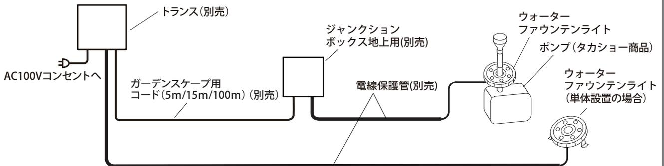
※地中配線の場合は、ライトの電源コードを必ず電線保護管(別売)に通し、不乾性パテ(別売)で止水処理を行ってください。
