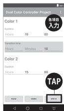
**B** 【WRITE】をタップした後 にスマートフォンをデュ アルストリングのコント ローラーのサイドに密着 するようにかざします。
