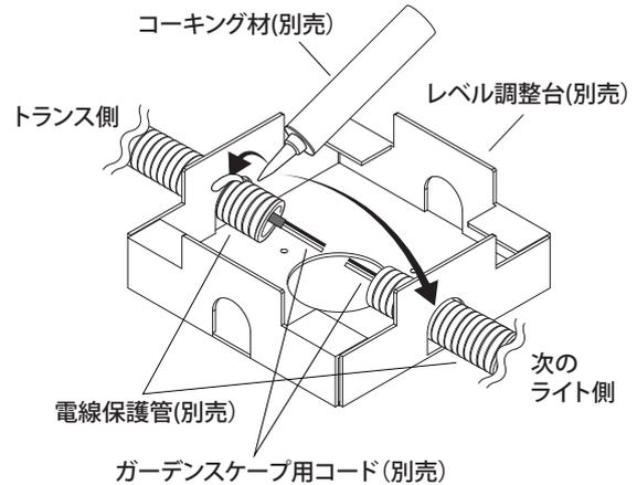
3. 電線保護管とレベル調整台の内側、外側のすき間へコーキング材(別売)を充填します。また、使用しない穴は養生してください。
