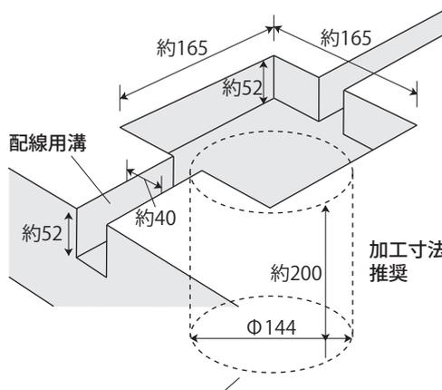
タイルドライート設置用穴 (先にレベル調整台を仮置きして水平に調整します) ※単位 mm
